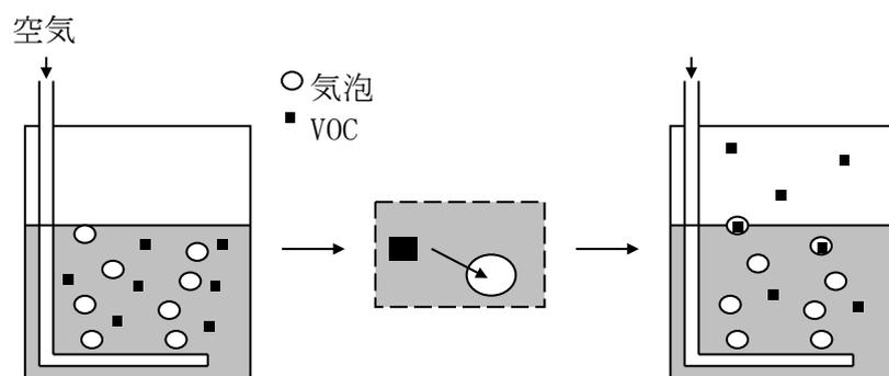
図-17 曝気法の原理
