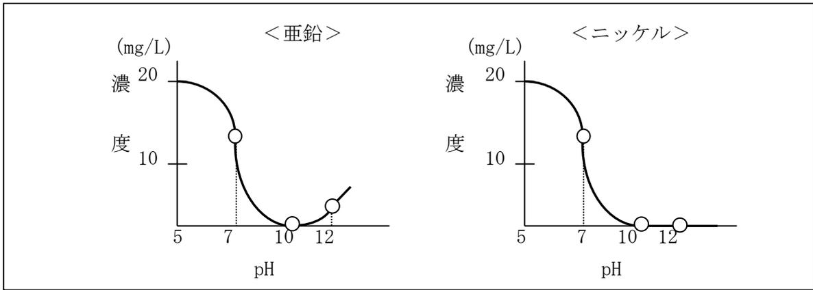
図-7 亜鉛、ニッケルの溶解度とpHの関係（使用アルカリ剤；水酸化ナトリウム）
