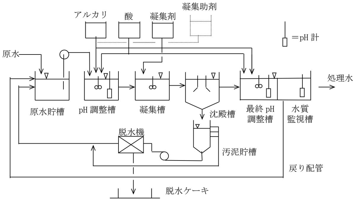
図-10 凝集沈殿法の全フロー
