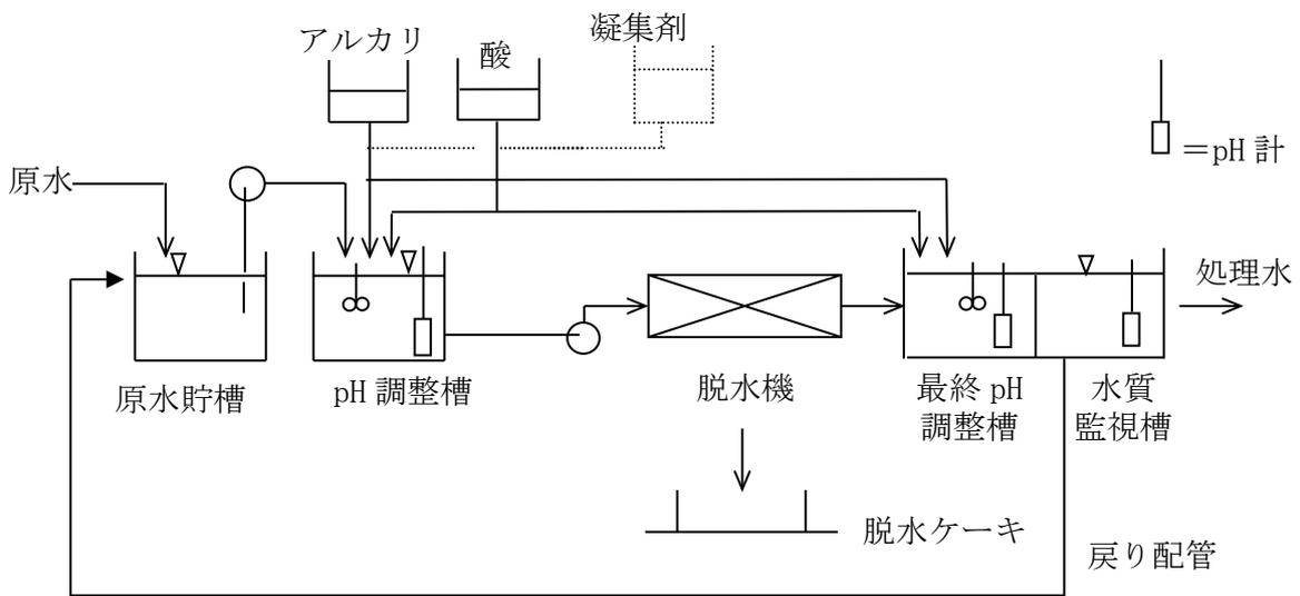
図-11 凝集・全量ろ過法の全フロー図
