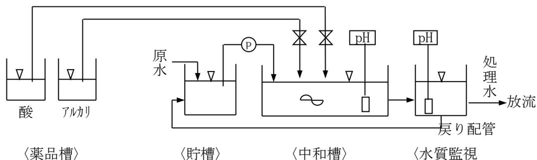
図-3 中和法による一般的処理フロー
