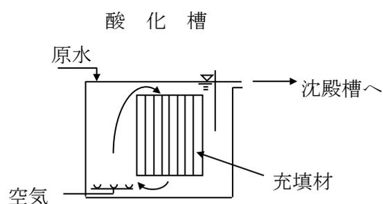
図-21 接触酸化法
