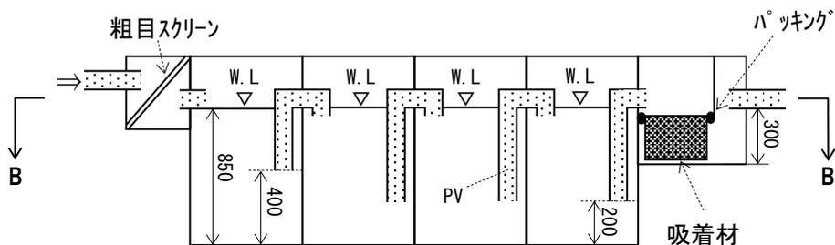
図-2 油水分離槽（A-A断面図）
