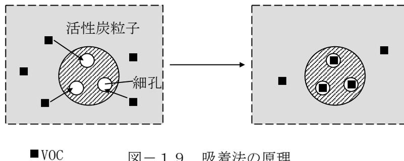
図-19 吸着法の原理
