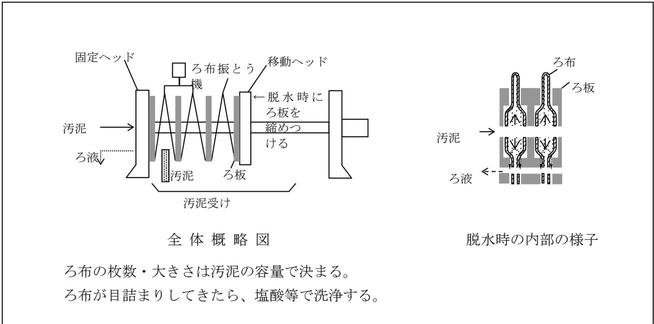
図-24 フィルタープレスの仕組み
