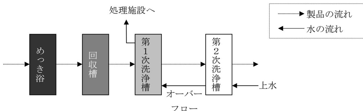
図-1 めっき作業における回収槽設置と向流多段式洗浄
