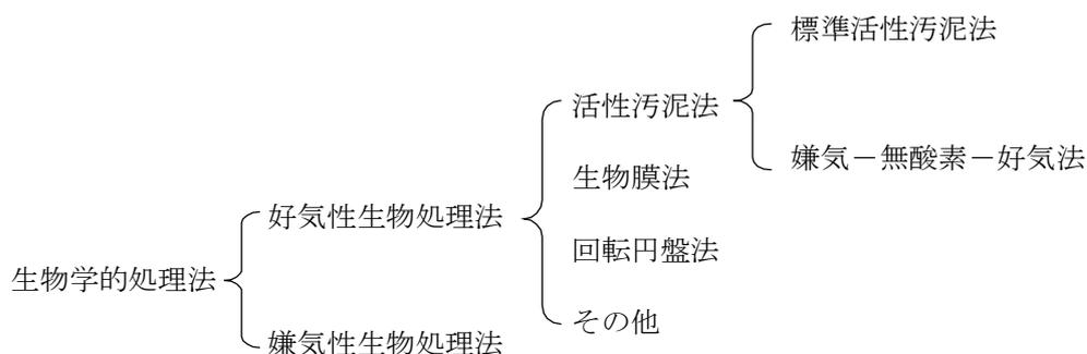
また、下水処理とは、端的に言えば「下水中の汚濁物質を固形物の形で分離すること」である。つまり、下水中から汚濁物質を除去し浄化された水（処理水）を得る工程（下水処理）と、分離した汚濁固形物（汚泥）を安定化させる工程（汚泥処理）から成り立つ。汚泥は別に減量化・処分されて一連の下水処理が完結する。
