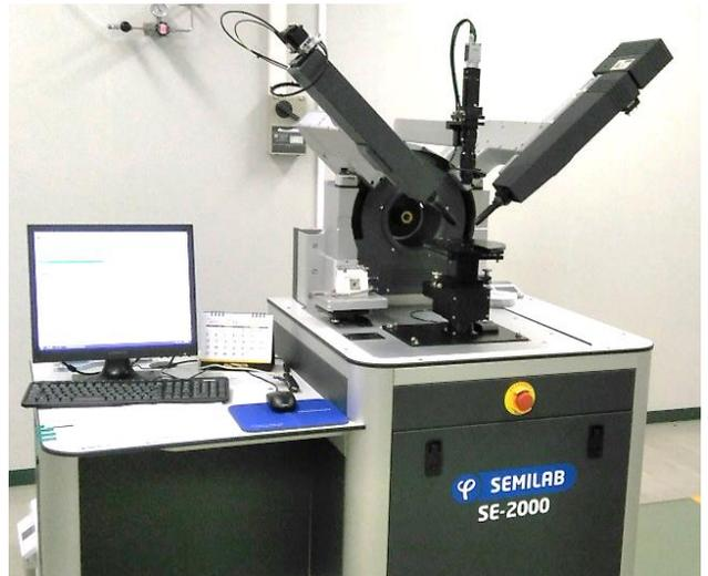
ナノからマイクロスケールの薄膜について、膜厚および屈折率や消衰係数といった光学定数などを、光を利用して非破壊で測定する装置です。
