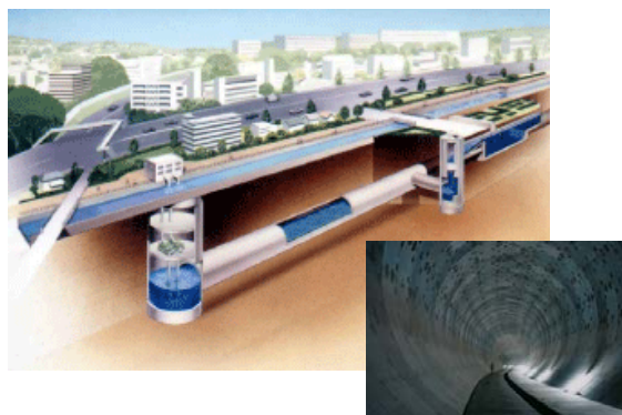
今井川地下調節池（イメージ及び内部）
