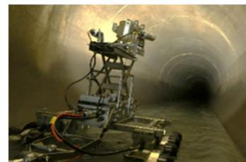
中大口径管用 TV カメラの例
