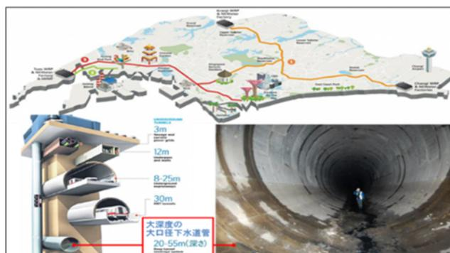
効率的な維持管理手法等の検討が進められているシンガポールの大深度の大口径下水道管
