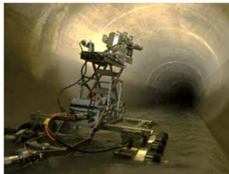
中大口径管用 TV カメラの例
