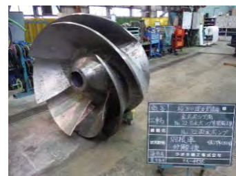
ポンプの再整備（長寿命化）
