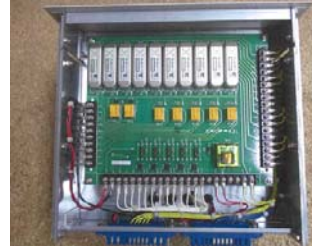
故障選択装置(出力回路基板)
