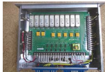
故障選択装置(出力回路基板)
