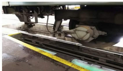
輪重測定装置
