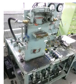
高さ調整弁・差圧弁用試験機
