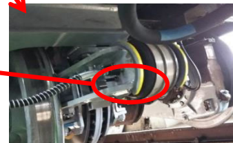
基礎ブレーキ装置
