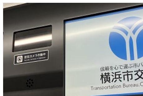
<4000形車両に設置した防犯カメラ>
