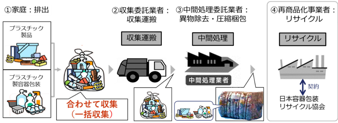
プラスチック資源の収集からリサイクルまでのフロー
