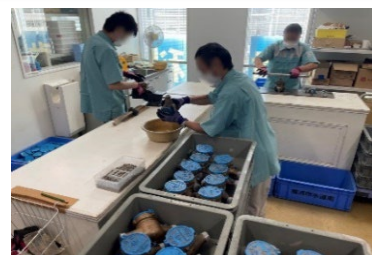
水道メーター分解作業
