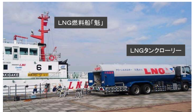
LNG充填中のタグボート
