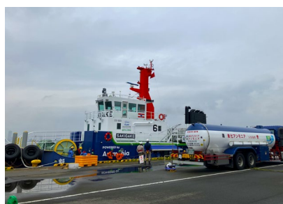
Truck to Shipによるバンカリングの様子
