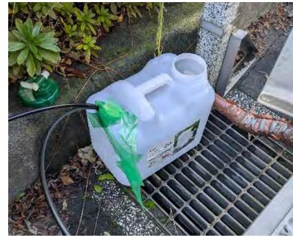
逆火防止のための水封処理
