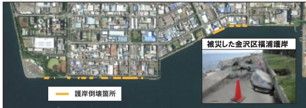
2019(令和元)年9月9日未明に東京湾を通過した令和元年房総半島台風(台風15号)では、観測史上最強クラスの勢力で東京湾各地において、記録的な暴風・波浪を観測するとともに様々な被害を及ぼしました。横浜港では、海面気圧969.1hPa、最大瞬間風速41.8m/sを観測し、特に護岸背後に多くの中小企業が立地する金沢区福浦・幸浦地区では、浸水により甚大な被害を受けたほか、護岸も延長約2.7kmのうち、約800mが倒壊しました。
