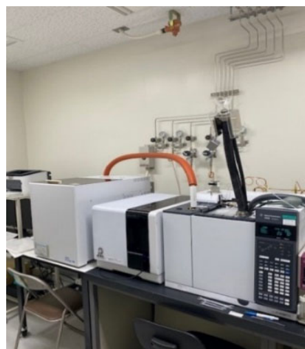
ヘッドスペースーガスクロマトグラフィー質量分析装置
