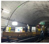
レーザーによるトンネル壁面の打音検査
