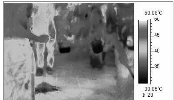
打ち水実施後 地表面温度 約37℃
