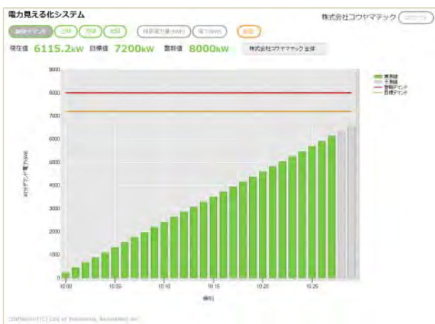
エネルギーマネジメントシステム 30分デマンド画面
