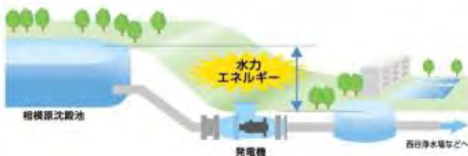
■ 小水力発電イメージ（川井浄水場）
