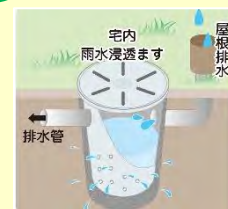
宅内雨水浸透ます
