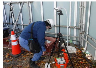
立入検査における作業場所近傍の石綿濃度測定の様子
