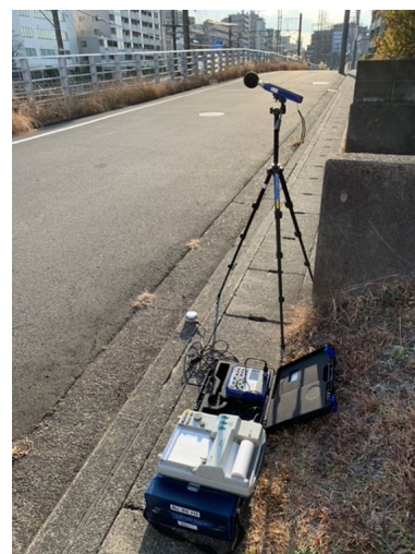
在来鉄道に対する 騒音振動測定の様子
