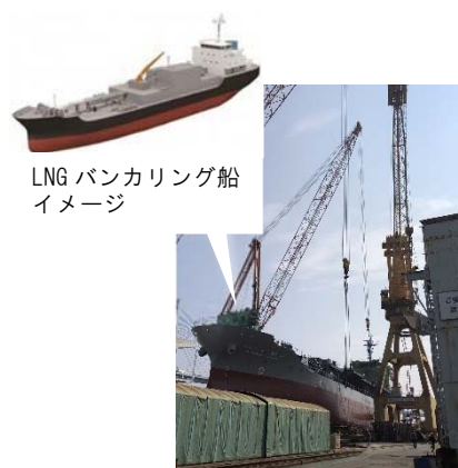
建設中の LNG バンカリング船 (エコバンカー SHIPPING ㈱提供)
