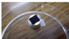
図5 カーボン導電テープのカバーを外した試料台
