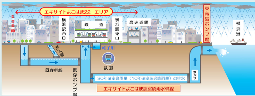
エキサイトよこはま龍宮橋雨水幹線と東高島ポンプ場の整備イメージ
