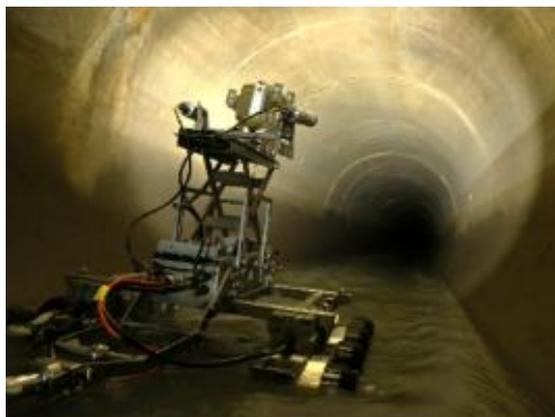
図 2-12 中大口径管の調査状況
