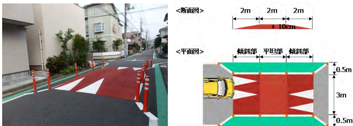
図 5-58 生活道路における自動車速度抑制対策の社会実験（ハンプ、狭さく）
