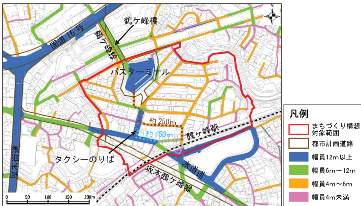
図・鶴ヶ峰駅北口周辺の道路幅員の状況 出典：都市計画基礎調査（平成25（2013）年、横浜市）
