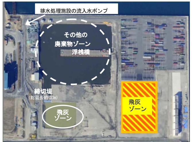
図-2 飛灰埋立ゾーン
