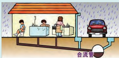
合流式下水道 Combined System
