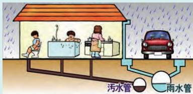
分流式下水道 Separate System
