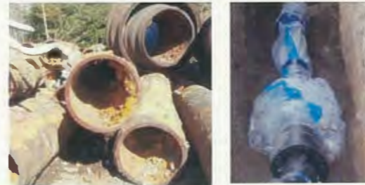
鋳鉄管(GIP) ※赤水や漏水の発生原因 ダクタイル鋳鉄管(DIP) ポリエチレンスリーブ有
