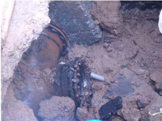
本管から分岐した直径40センチの受口の離脱部分
