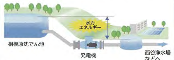
小水力発電イメージ（川井浄水場）
