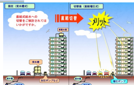
直結給水への切り替え (イメージ)
