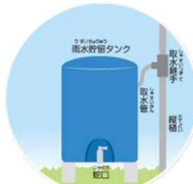
雨水貯留タンク
