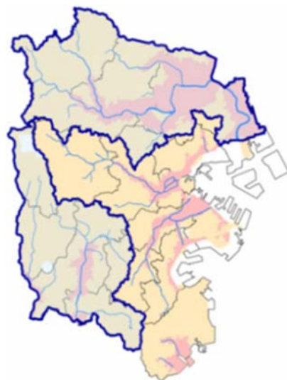
○ : 約 50mm/h 整備対象区域 (下水道) ○ : 約 60mm/h 整備対象区域 (下水道) ○ : 特定都市河川の指定に伴い総合治水対策により河川整備等で約 60mm/h 対応する流域 (鶴見川流域、境川流域)
