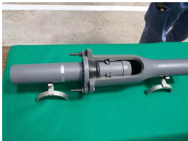
小口径耐震管の採用 （50mmダクティル鑄鉄管）
